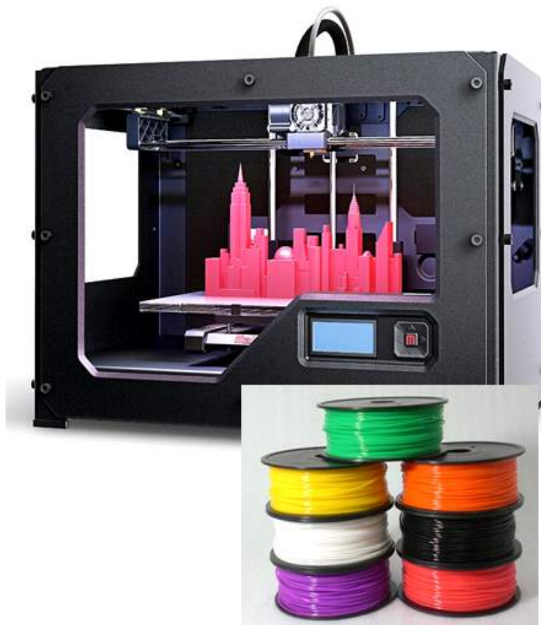
<그림 7> 3D 프린터와 프린트 용 PLA 모노필라멘트
